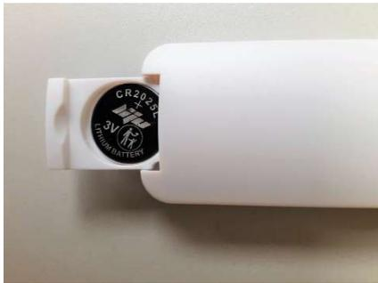
Die Fernbedienung zu dem Gerät enthält eine Batterie (Knopfzelle 3V CR2025 Li).
